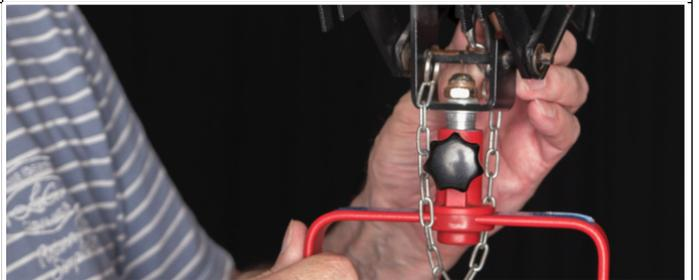
Schlecht befestigt ist der Blitzkopf, wenn der Zapfen bis zum Anschlag ganz in die Hülse gesteckt und befestigt wird. Besonders schlecht ist, wenn dann der Blitzkopf nicht mit der Sicherungskette gesichert ist. Noch einmal: Schraube IN die BOHRUNG vom Zapfen drehen.
