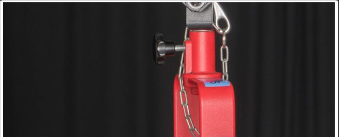
**KLEMMSCHRAUBE IN DIE BOHRUNG DES ZAPFEN DREHEN ! DAS IST LEICHT ZU ERKENNEN, WENN MAN DEN BLITZKOPF NICHT MEHR VERDREHEN KANN (WENN ER NOCH NICHT GANZ FESTGESCHRAUBT IST UND DAS SICHTBARE GEWINDE DER SCHRAUBE IST KÜRZER). BLITZKÖPFE MITTELS KETTE SICHERN !**
