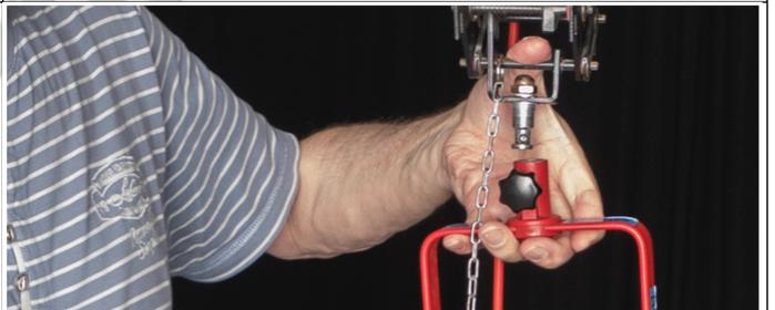
5) Die Sicherungskette unten um den Bügel herum fädeln, von vorne oder hinten ist egal, und den Karabiner an der Querstange, an der die Sicherungskette befestigt ist, einhängen.
