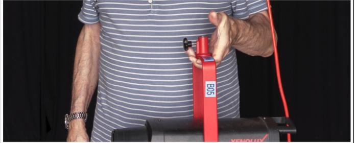
3) Die Schere mit der rechten Hand an der Sicherungskette herunterziehen und mit dem Daumen der linken Hand hinten an der Querstange, an der auch die Sicherungskette befestigt ist, halten. Dort wo das Kabel in der Schere herunterkommt ist hinten und wo die Bohrung im Zapfen ist ist vorne.
