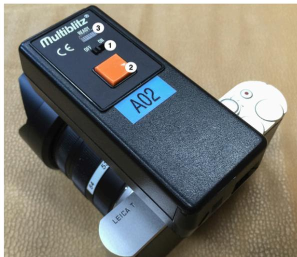
Jeder Funkauslöser besteht aus einem Sender, der auf den Blitzschuh der Kamera gesteckt und einem Empfänger, der per 3,5 mm Klinkenstecker mit dem Synchronanschluss am Blitzkopf verbunden wird (am Xenolux 1000 und X5 unten).
